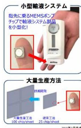
「次世代型輸液システムに向けてのコア技術開発」として採択、キーデバイスの製造装置開発でエス・エス・アロイも加わり、開発が進められた。具体的には圧電素子の原理を応用したマイクロマシン（MEMS）のマイクロポンプデバイスを製作、液体が流れるラインから取り外さず、ポンプの吸込口側から吐出口側に向かって液体が
