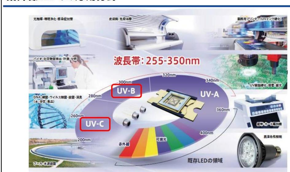
で注目度が高い。殺菌に最も効果的な 260nm 周辺 DUV-LED は薬品を使わず、環境にやさしい殺菌が手軽にでき、今後、飲料水や食品、空気など幅広い分野での使用が期待される。特に発展途上国では、汚水処理施設の未整備による水の汚染が伝染病の蔓延の温床となっており、太陽光発電と組み合わせて利用すれば、泥水でも浄化して使えるなど、世界の命を救う「魔法の光」として期待されている。なお、従来紫外線殺菌などの用途では水銀ランプ（発行波長 254nm）が広く用いられてきた。しかしガス光源は寿命が短く、発光波長がガスの輝線のみで限定され、水銀などの人体・環境に有害な物質を含み、光源サイズ、消費電力が大きく利用範囲は限定的だった。加えて 2013 年 10 月「水銀に関する水俣条約」が採択され、水銀などの人体・環境に有害な物質の削減・廃絶に向け、2020 年以降、水銀を含む製品の輸出入が原則禁止される。このため既存のガス光源を置き換える新たな光源の開発実現が急務で、省スペース、省エネ、長寿命で電力コストも抑えられ、水銀フリーである深紫外 LED への代替技術実現への要請が高まることも追い風となる。
