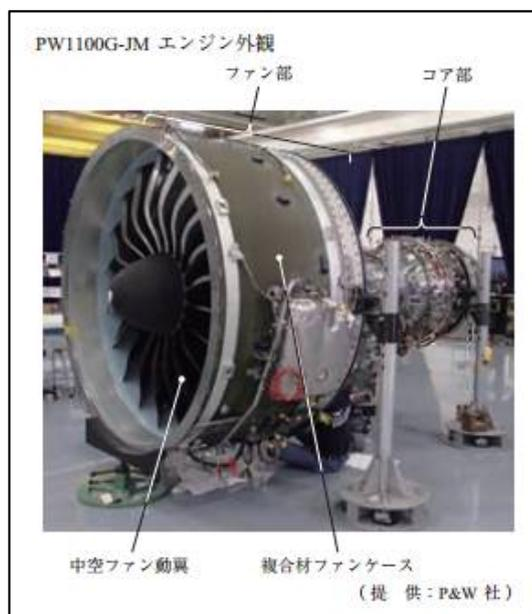
の大きさがファンを駆動させるコア部分対比で大きく、ファンケースで CFRP による軽量化が必要不可欠で、同社としてエンジン部品として初めての採用となった。2015 年より生産を開始したが、同機は 2010 年 12 月に受注開始し現在の確定受注は 4000 機以上 (A320neo は P&W 社製もしくは CFM インターナショナル製のいずれかを搭載でほぼ 2 分予想)、2016 年より納入開始のため、2016 年 8 月に東村山工場にファンケースライナー設備を新設、静岡と並行生産している体制から 2017 年中旬には東村山工場に集約する計画である。
