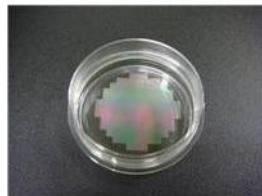
■細胞培養面に微細構造を形成した細胞培養用ディッシュ
