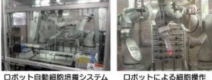
ロボット自動細胞培養システム      ロボットによる細胞操作
