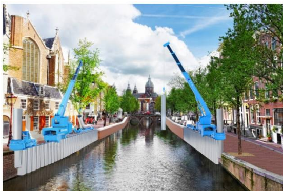
「ジャイロプレス工法」と「GRBシステム」による施工イメージ図
