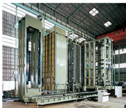
CCL成形用36段プレス装置
