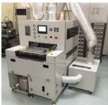
(左) IoTに対応したはんだ付け装置 (右) システム連動イメージ
