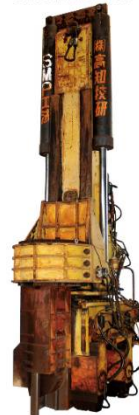
サイレントパイラー1号機
